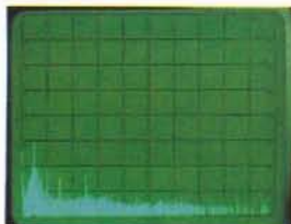
Analisi spettrale della distorsione armonica, amplificatore non magnetico
